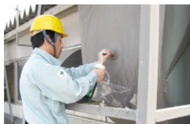
排気ダクトの臭気サンプリング
